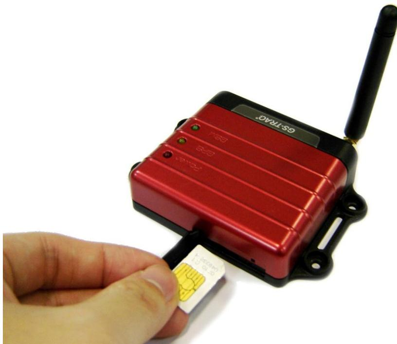
Откройте резиновую заглушку разъёма SIM-карты на корпусе трекера. Установите SIM-карту в слот как показано на фото – металлическими контактами вверх, скошенным углом вперед.
